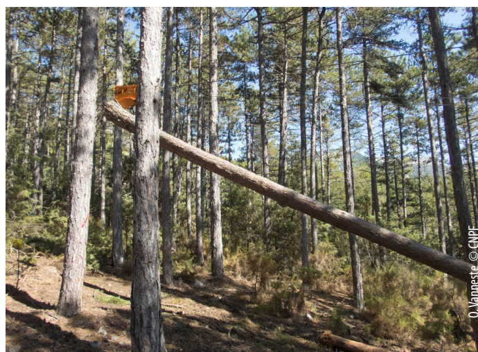
Le mât, attelé sur un tracteur agricole, est haubané sur des arbres. Les bois sont tirés par le pied de l'arbre et la cime traîne au sol.
