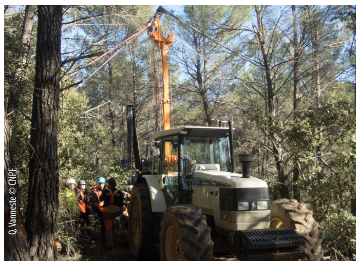
Le mât, attelé sur un tracteur agricole, est haubané sur des arbres. Les bois sont tirés par le pied de l'arbre et la cime traîne au sol.
